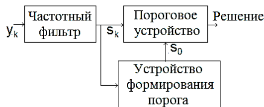
Рис. 1. Обобщенная структурная схема обнаружителя радиосигналов
